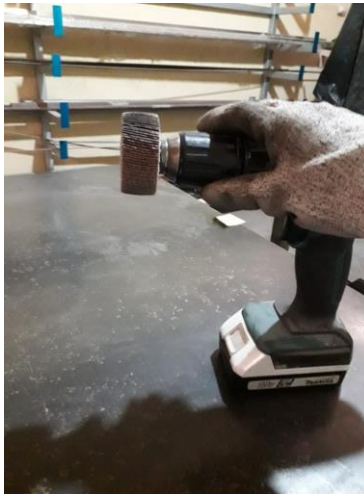
Figura 42: Colocar rodillo de lija en taladro.
