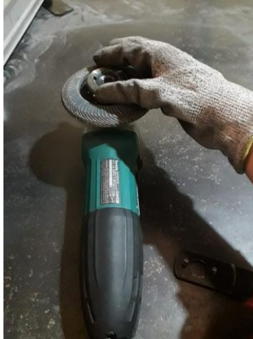
Figura 36: Colocando seguro a disco.
