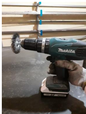
Figura 40: Dando presión a la sujeción con el botón de accionar taladro.
