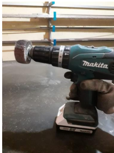
Figura 43: Ajuste de presión con el botón de accionamiento de taladro.
