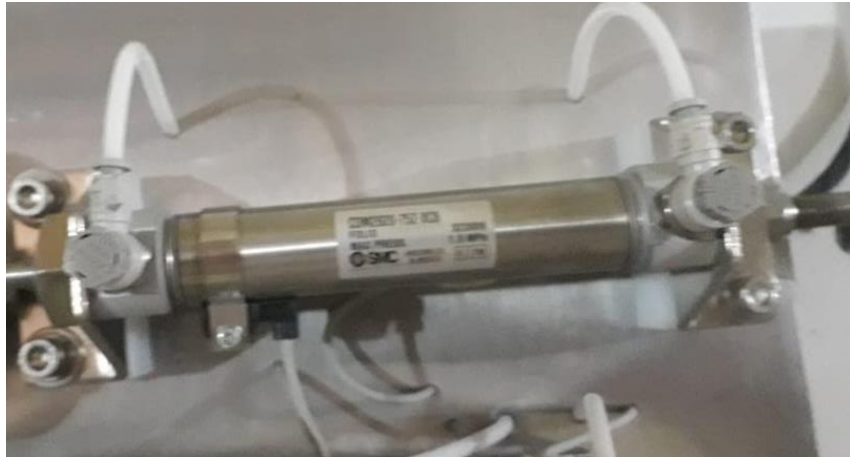
Figura 55: Cilindro con válvulas reguladoras de caudal.
