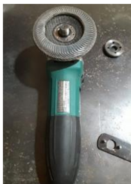
Figura 35: Disco ubicado en la pulidora.
