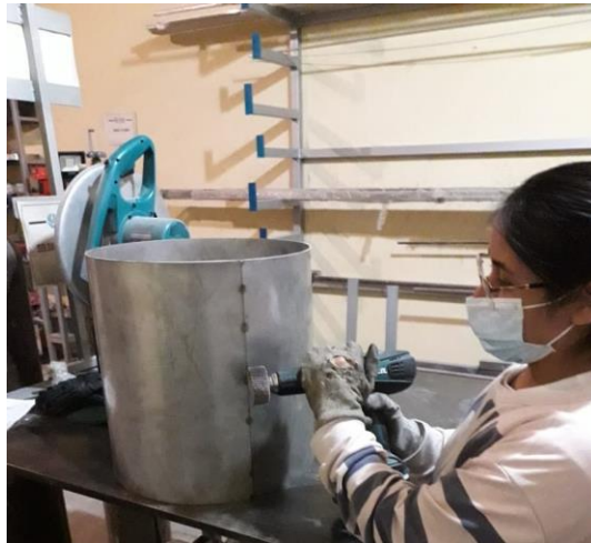
Figura 44: Ejecutando el proceso de acabado con rodillo de lijas.
