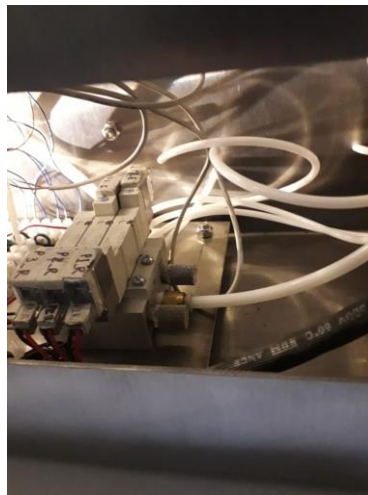
Figura 54: Ensamble de componentes neumáticos por dentro.
