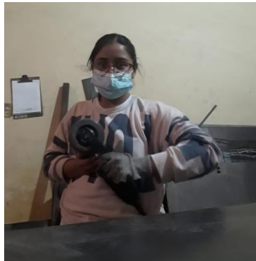
Figura 37: Ajuste de disco a pulidora con llave.
