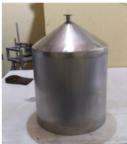
Figura 58: Tolva con acabados finales.
