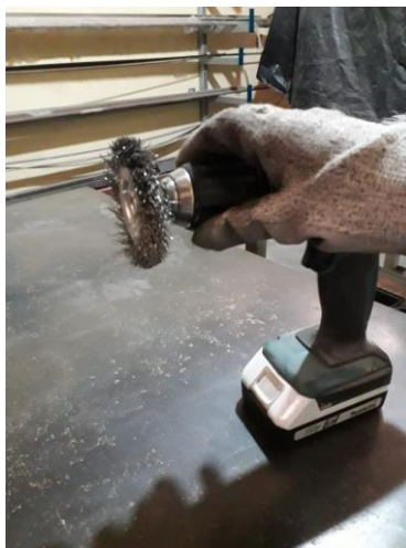
Figura 39: Colocación de cepillo de alambre.
